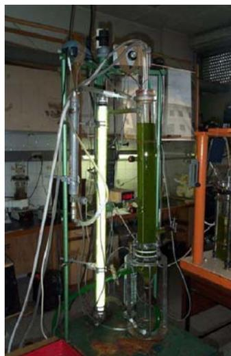
Nel secondo impianto, anch'esso a sviluppo verticale come il precedente, la sorgente luminosa è situata all'interno e coassialmente al reattore tubolare (riser). L'impianto è completato da una colonna in vetro della capacità di 5 l (downcomer). La circolazione del fluido è ottenuta tramite air-lift.
